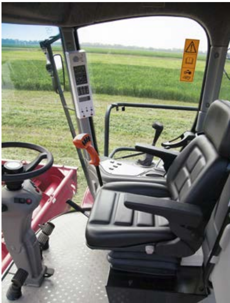
Панель управления с удобным расположением кнопок, интуитивно понятной символикой и контрастной маркировкой.
